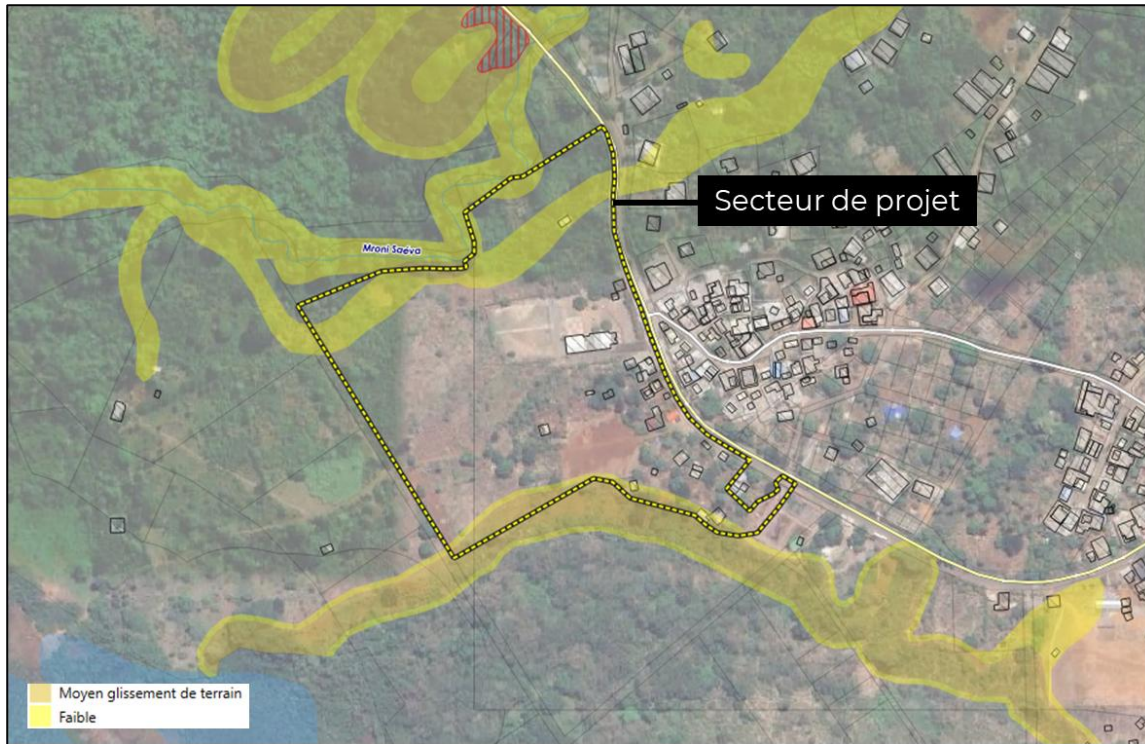
Figure 20 : Zones d'aléa mouvements de terrain sur le site du futur centre sportif (source : DEALM Mayotte via Observatoire de Mayotte. Dernière mise à jour : mai 2022)
